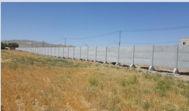
◀ دیوار تیپ ۳ - دورونما - ارتفاع: ۳/۶ متر، طول دهانه: ۴/۱۲۵ متر، ضخامت پنل: ۱۰ سانتی متر - مسلح
